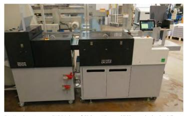
Die Kombination aus FKS/Multigraf CPC375 XPro und TCF375 erlaubt das Rillen, Perforieren, Schneiden und Falzen bei Kolumbus seit Mai in einem Arbeitsgang.
