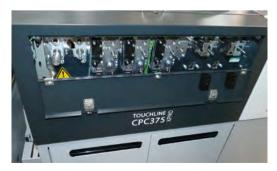
Die Modulaufnahmen an der FKS/Multigraf CPC375 XPro sind leicht zugänglich. Die eingeschobenen Module werden über ein Touchscreen-Display intuitiv angesteuert.
